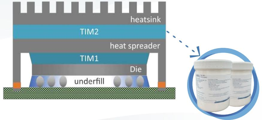
導熱膏是一種具有良好導熱性的熱界面材料(下稱TIM2)，其係用於填充兩種材料接觸面上的微孔隙和不平孔洞。TIM2具有無需固化之特性，係藉由在材料界面上施加特定壓力來固定及填充在電子元件(如晶圓蓋板與散熱鰭片)間的導熱膏，以建立良好導熱通道。隨著對熱管理的更高要求，GTA提出了創新和優化的TIM2，使產品能有效改善元件間的傳熱效率，對電子設備的性能、使用壽命和穩定性起著重要作用。TIM2可廣泛應用於電子產品、汽車電子、電信、消費電子、LED、液晶電視等，也可用於任何需要熱管理解決方案的應用。
